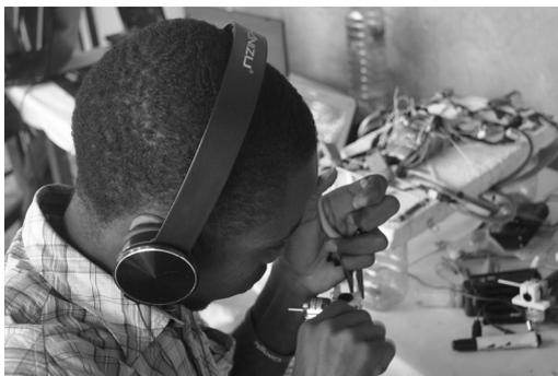
**Samuel Amoako-Frimpong realiza ajustes en el anclaje de los motores del *quadcopter* (Autor: AMP)**
