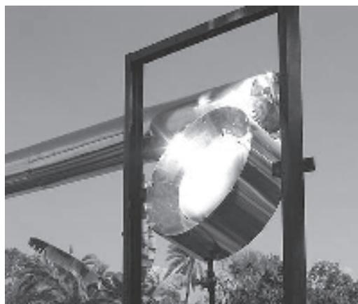
Receptor de 11 litros de volumen. Se observa que el foco solar tiene un diámetro de 30 cm aproximadamente.
