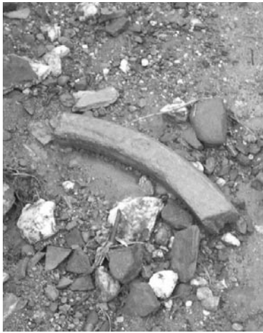
Figura 3 Residuos de fibrocemento en camino público de parque forestal (2004)
