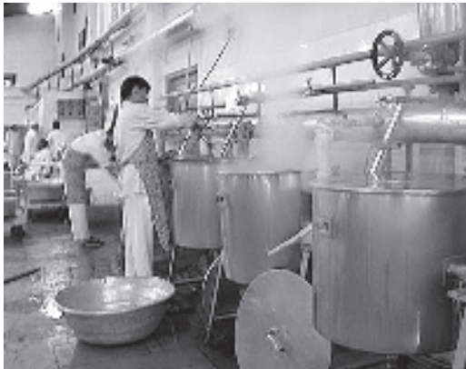
Interior de las instalaciones de la cocina solar de Taleti. Cada olla tiene capacidad para 200 litros.
