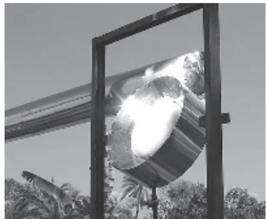
Receptor de 11 litros de volumen. Se observa que el foco solar tiene un diámetro de 30 cm aproximadamente.
